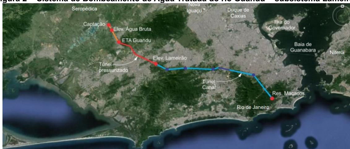
Figura 2 - Sistema de Bombeamento de Água Tratada do rio Guandu – subsistema Lameirão.
