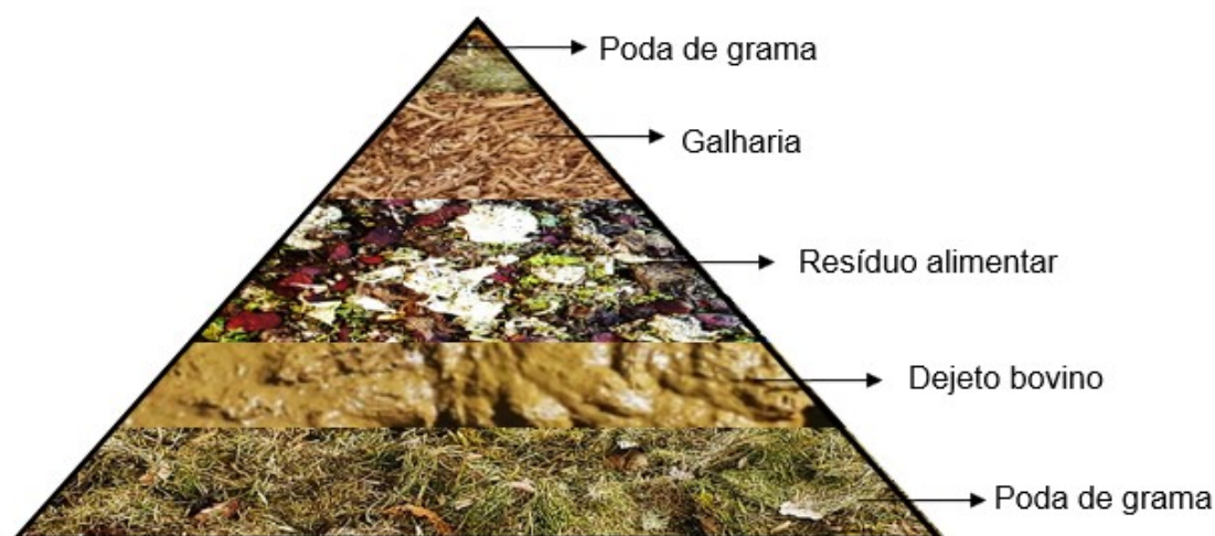
Figura 6 – Montagem da leira de compostagem
