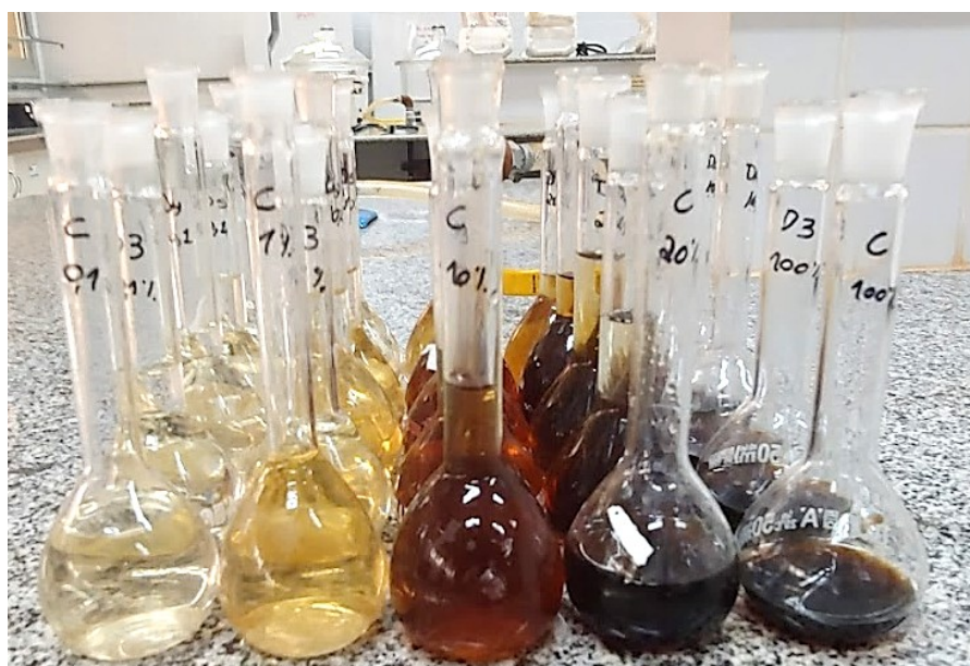
Figura 22 – Diluição das amostras 100:0, 20:80, 10:90, 1:99 e 0,1: 99,9
