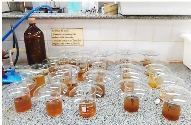
Figura 18 – Digestão das amostras em solução de Melich
