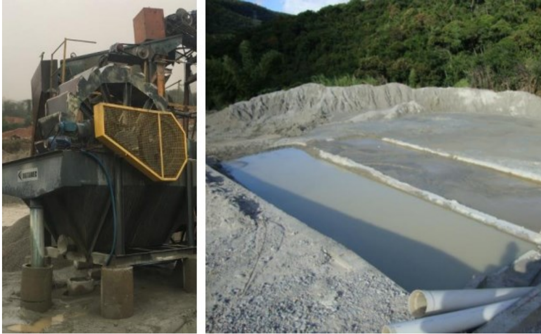
Figura 7 - Processo via úmida com roda d' água e bacias de decantação. Fonte: Schankoski (2017).
