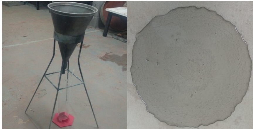
Figura 22 - Ensaio de Cone Marsh e Mini Slump. Fonte: Autoria própria (2023).
