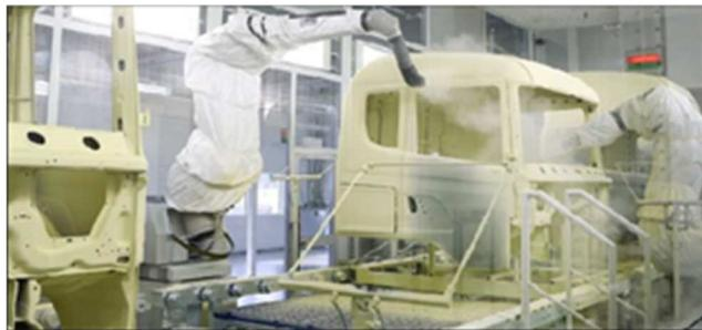
Figura 32 – Área Robotizada de Pintura
