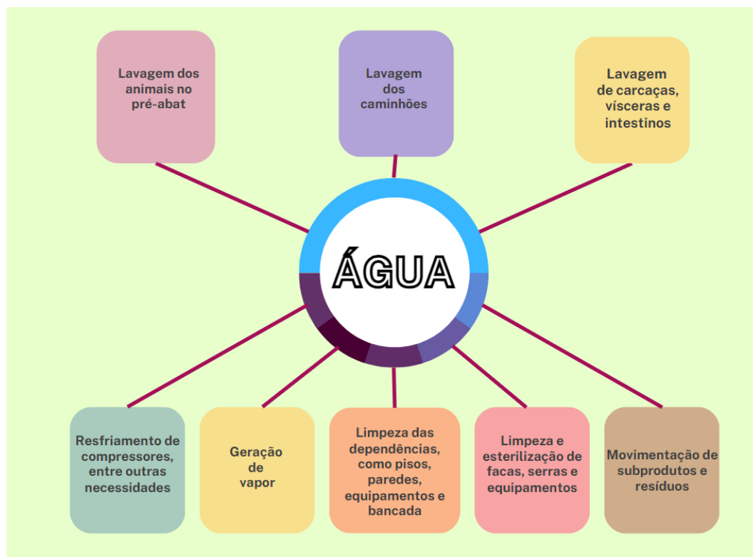
Figura 3 – Esquema da utilização da água em uma planta frigorífica de abate de suínos
