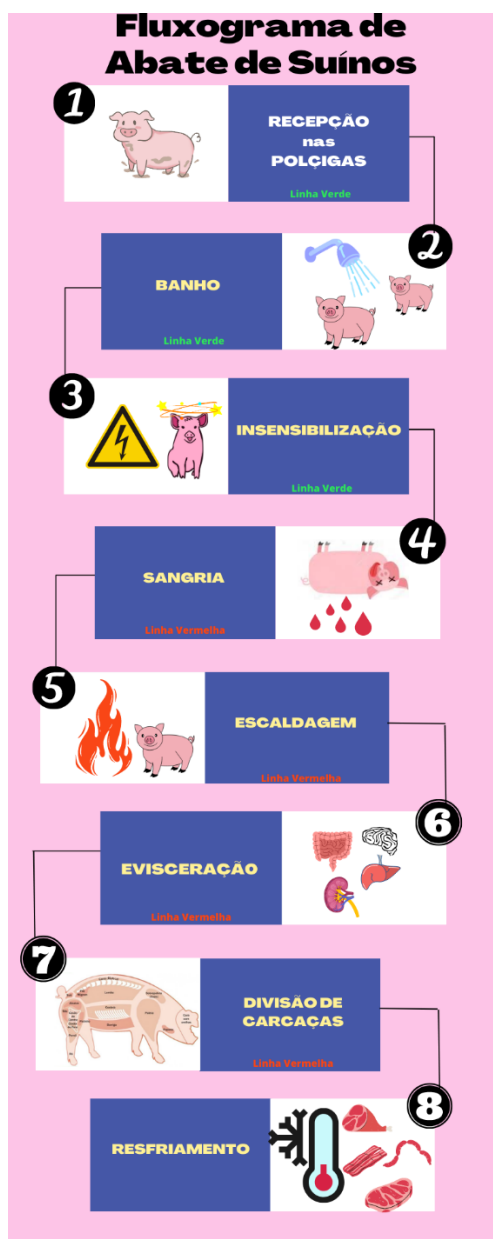
Figura 2 – Fluxograma simplificado das etapas do processo de abate de suínos com indicação a qual linha os resíduos da etapa pertencem
