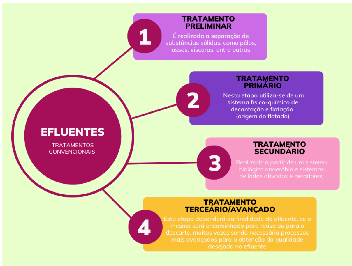
Figura 5- Diagrama com a representação do tratamento convencional de efluentes em plantas frigoríficas
