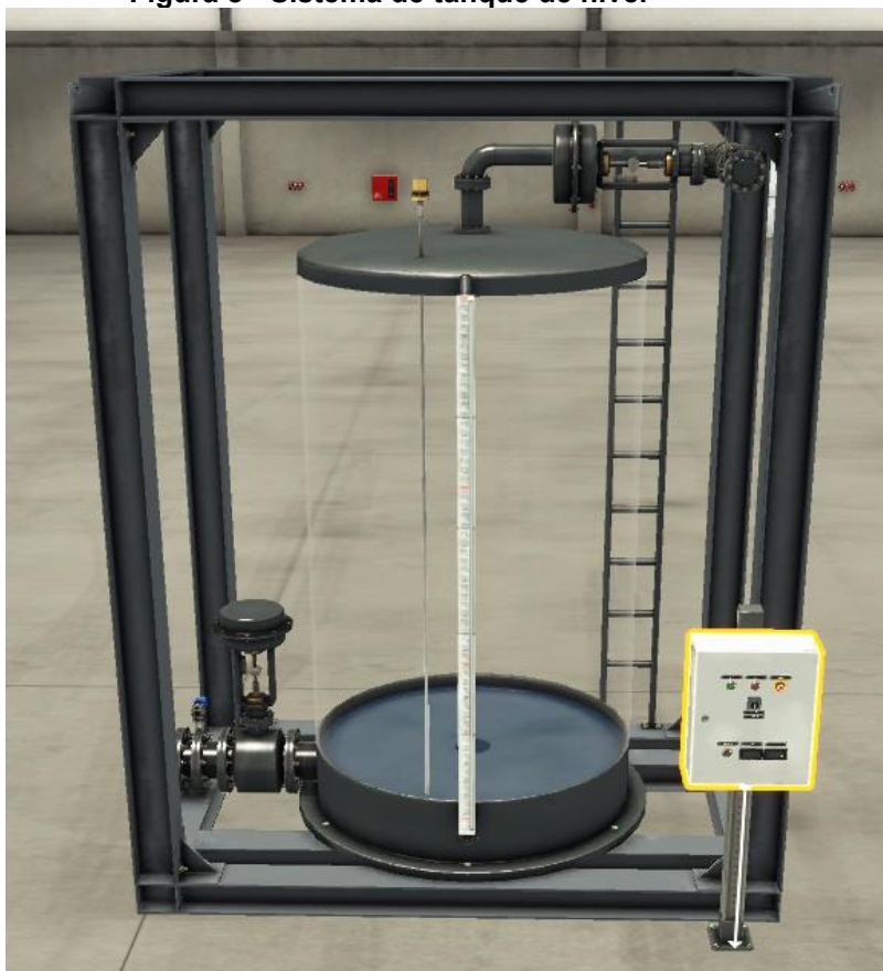
Figura 8 - Sistema de tanque de nível
