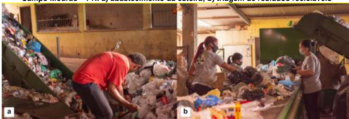
Figura 7 – Registro fotográfico do processo produtivo da Cooperativa Resíduo Solidário, Campo Mourão – PR. a) abastecimento da esteira; b) triagem de resíduos recicláveis
