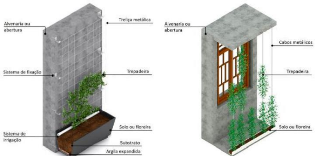
Figura 8 – Extensivo - Fachada verde indireta com treliça e com cabos
