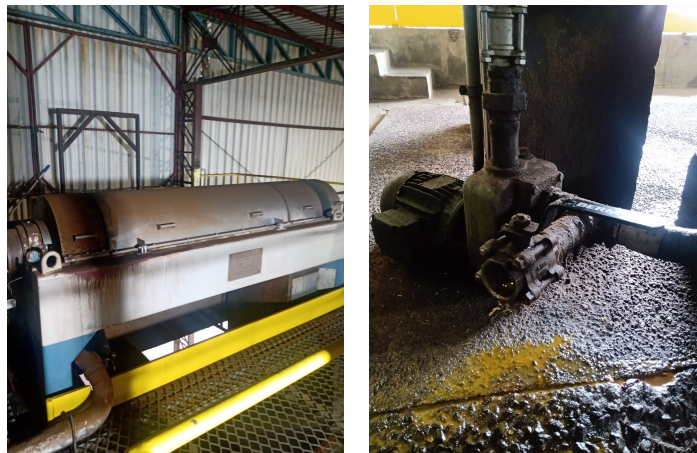
Figura 4 – Centrifuga Tridecanter: (a) Centrifuga, (b) Saída da tridecanter (a) Centrifuga (b) Saída da tridencanter
