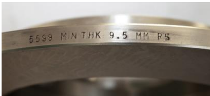
Figura 25 - Rotor com especificação de espessura mínima do fabricante
