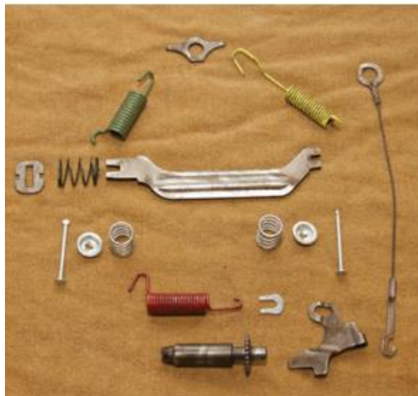
Figura 18 - Exemplo de molas e cliques de retenção no sistema de freio
