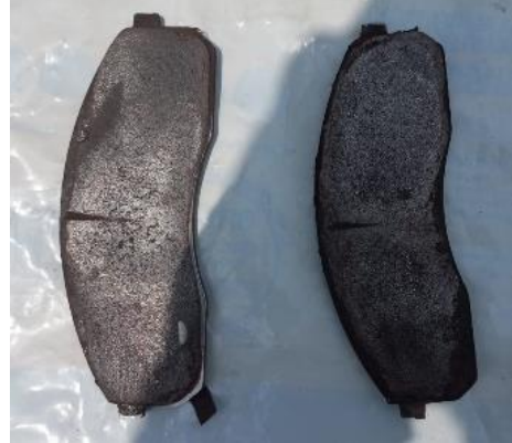
Figura 30 - Pastilhas de freio usadas
