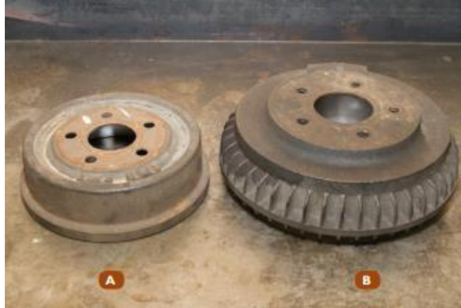
Figura 11 - Tambor de freio. A. Sem aletas. B. Com aletas
