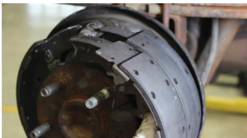
Figura 16 - Erros comuns na montagem das sapatas de freio
