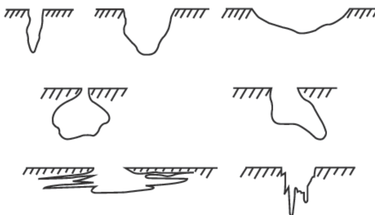
Figura 3 - Formas de pites segundo a norma ASTM G 46-76.
