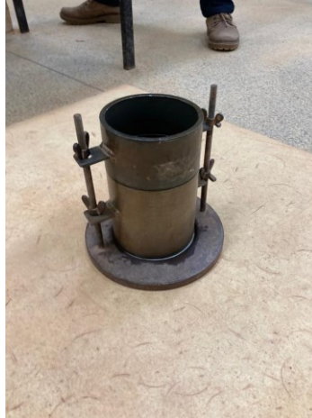
Fotografia 6 - Cilindro metálico de tamanho pequeno utilizado no ensaio de compactação
