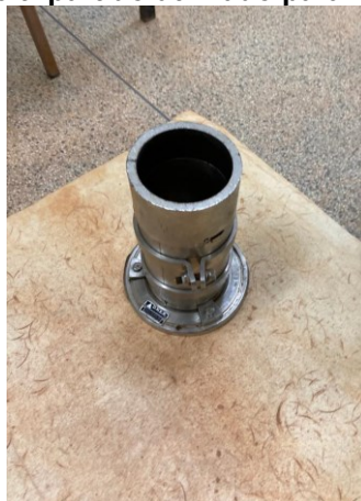
Fotografia 9 - Cilindro metálico tripartido utilizado para moldagem dos corpos de prova
