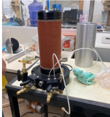
Fotografia 11 - Corpo de prova, pedras porosas e top-cap posicionados
