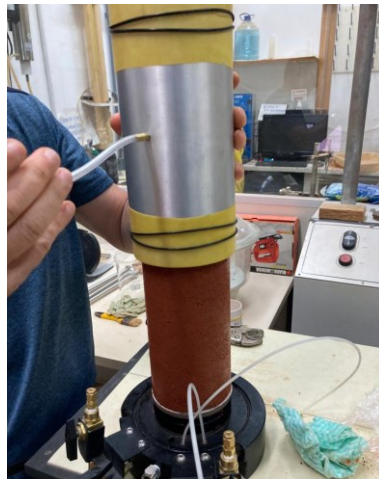
Fotografia 12 - Encamisador e membrana de borracha com anéis elásticos de borracha
