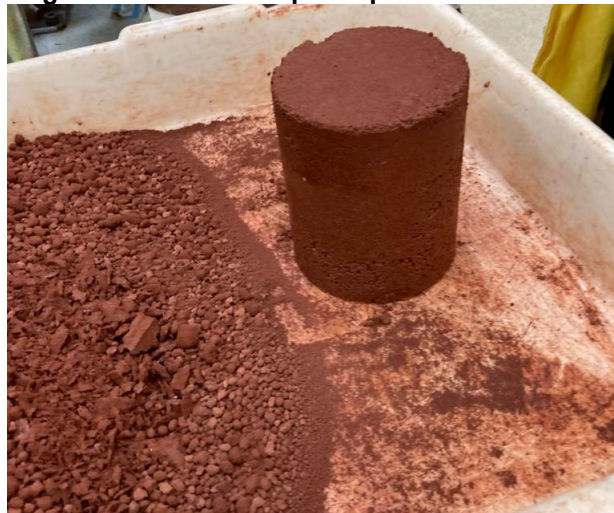
Fotografia 8 - Amostra após o processo de extrusão
