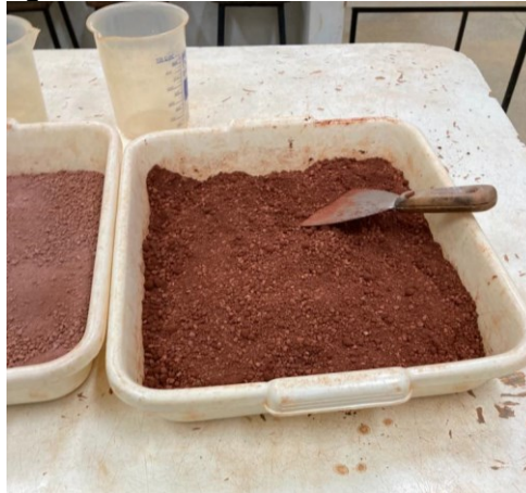
Fotografia 5 - Mistura do solo-cal com a água
