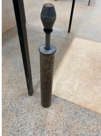
Fotografia 7 - Soquete pequeno utilizado para ensaio de compactação
