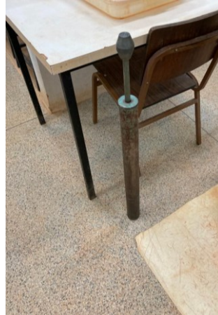
Fotografia 10 - Soquete metálico de tamanho grande utilizado para moldagem dos corpos de prova
