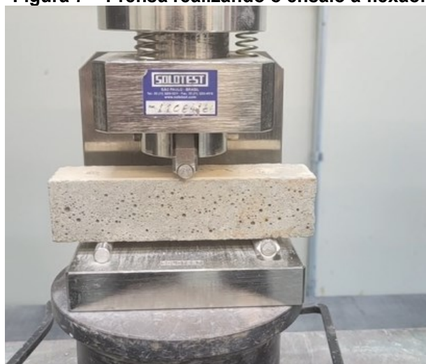
Figura 7 – Prensa realizando o ensaio à flexão.
