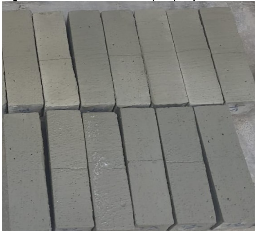
Figura 19 – Visibilidade das fissuras após aplicação do aditivo 1.
