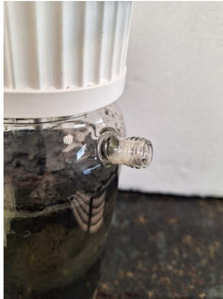
Fotografia 3- Enxofre elementar na saída de biogás
