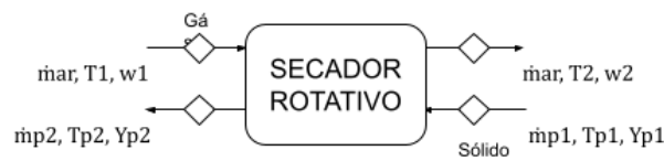
Figura 27- Processo de secagem do subproduto
