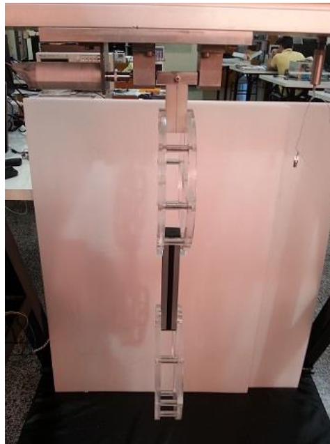
Figura 36 - Ensaio do corpo da aeronave para determinação do momento de inércia em z.
