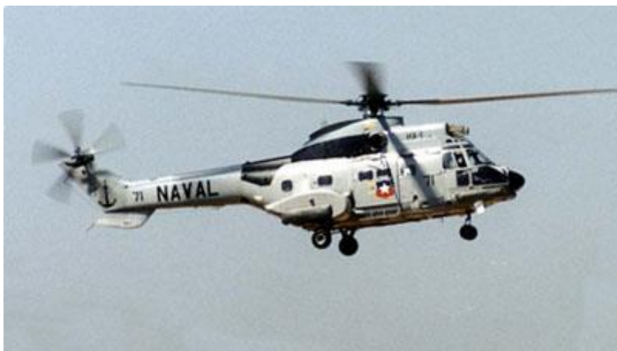
Figura 1 - Helicóptero com uma hélice principal e uma hélice lateral na cauda Fonte: United States Navy (2014).
