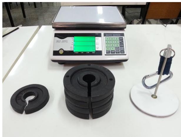
Figura 19 - Medição dos pesos de anilhas pela balança Fonte: Autoria própria.
