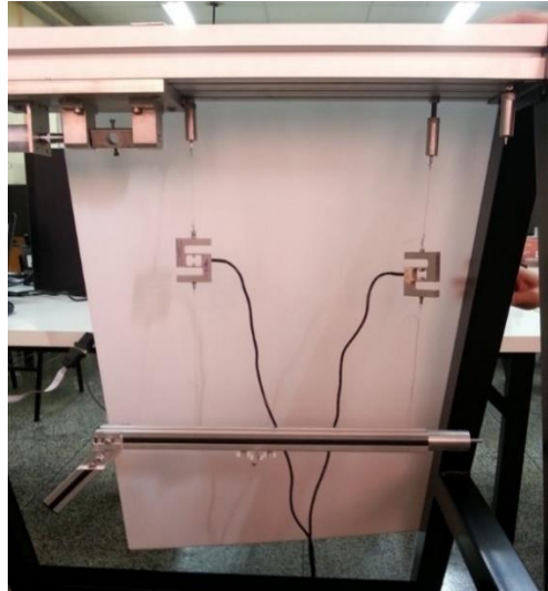
Figura 39 - Ensaio do braço de sustentação para determinação do centro de massa do eixo x , através de reações estáticas Fonte: Autoria própria.
