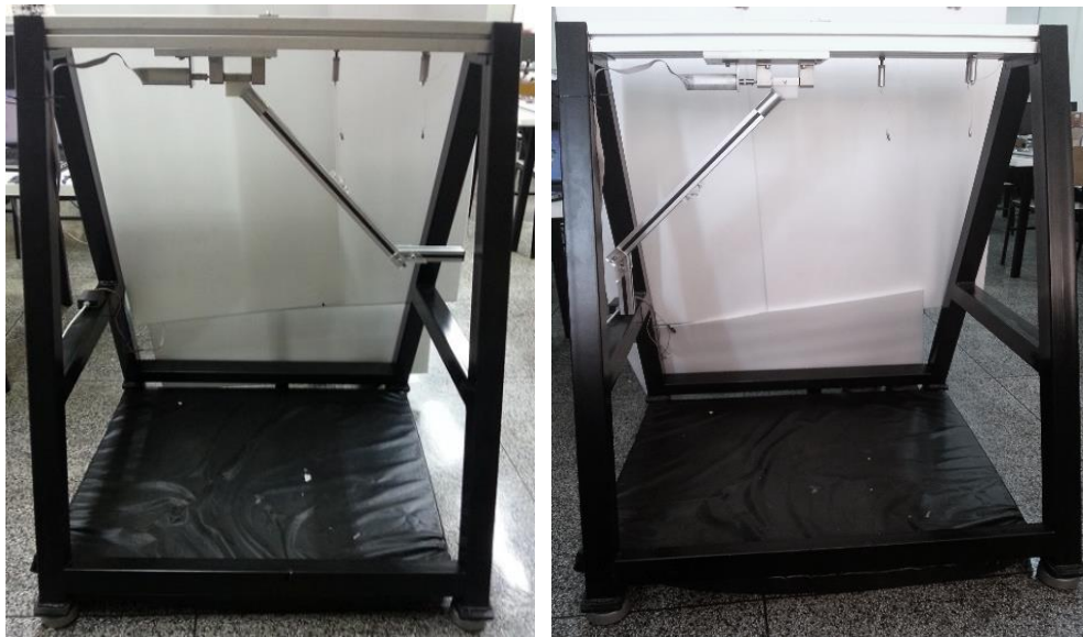
Figura 44 - Determinação do momento de inércia I_{OL1} e I_{OL2} , com ângulo de inclinação 45^\circ e 135,2^\circ respectivamente.
