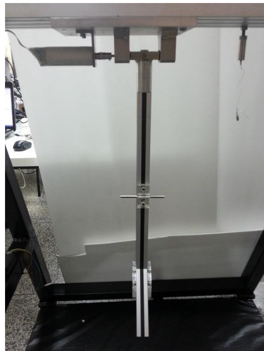
Figura 43 - Ensaio do braço de sustentação para determinação do momento de inércia em z
