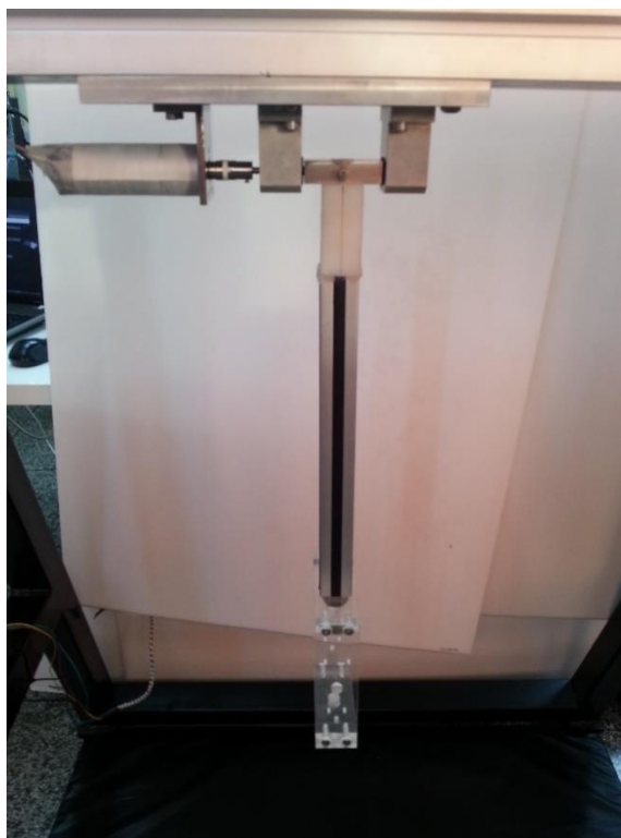
Figura 31 - Ensaio para determinação do período de oscilação do conjunto haste na coordenada z. Fonte: Autoria própria.
