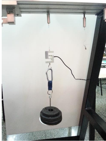
Figura 18 - Procedimento de calibração das células de carga Fonte: Autoria própria.
