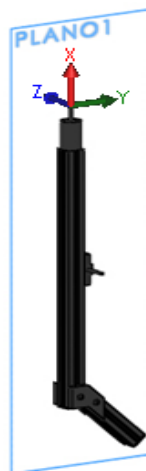
Figura 38 - Representação do plano de simetria presente no conjunto braço de sustentação
