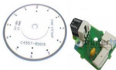
Figura 24 - Encoders para leitura de posição angular Fonte: Autoria própria.
