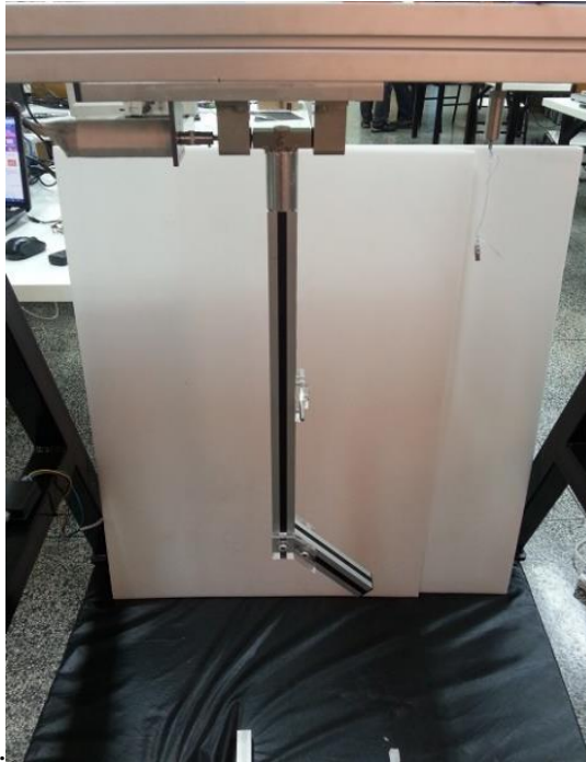
Figura 42 - Ensaio do braço de sustentação para determinação do momento de inércia em y
