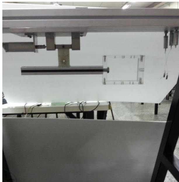
Figura 30 - Ensaio para determinação do período de oscilação do conjunto haste na coordenada y . Fonte: Autoria própria.
