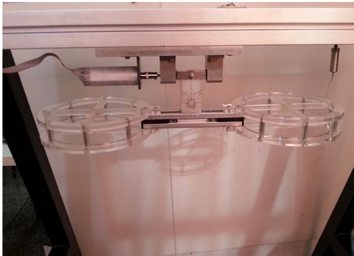
Figura 35 - Ensaio do corpo da aeronave para determinação do momento de inércia em y . Fonte: Autoria própria.
