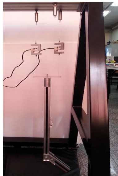
Figura 40 - Ensaio do braço de sustentação para determinação do centro de massa do eixo y , através de reações estáticas Fonte: Autoria própria.
