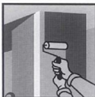
Figura 16- Sistema de aplicação das folhas flexíveis de compósitos de fibras de carbono
