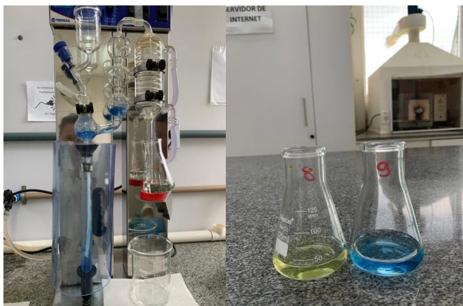
Figura 7 - Imagem mostrando a coloração verde claro após a digestão, e a coloração do ponto de viragem azul
