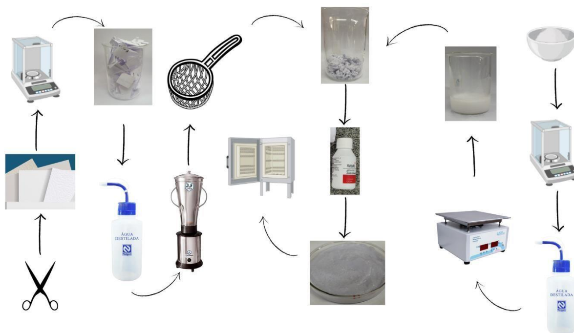
Figura 5 – Fluxograma do processo de síntese.
