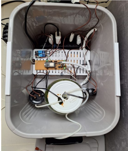
Figura 18 - Junção do circuito com o recipiente de cultivo
