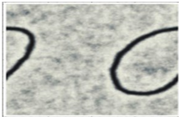
Figura 2.8: Defeitos do tipo linha surgem próximos à superfície planar. Fonte: Adaptada de Chiccoli (2015).
