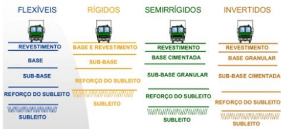
Figura 1- Diferença entre a estruturação dos pavimentos
