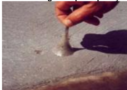
Figura 49 – Membrana gerada pela aplicação do selante
