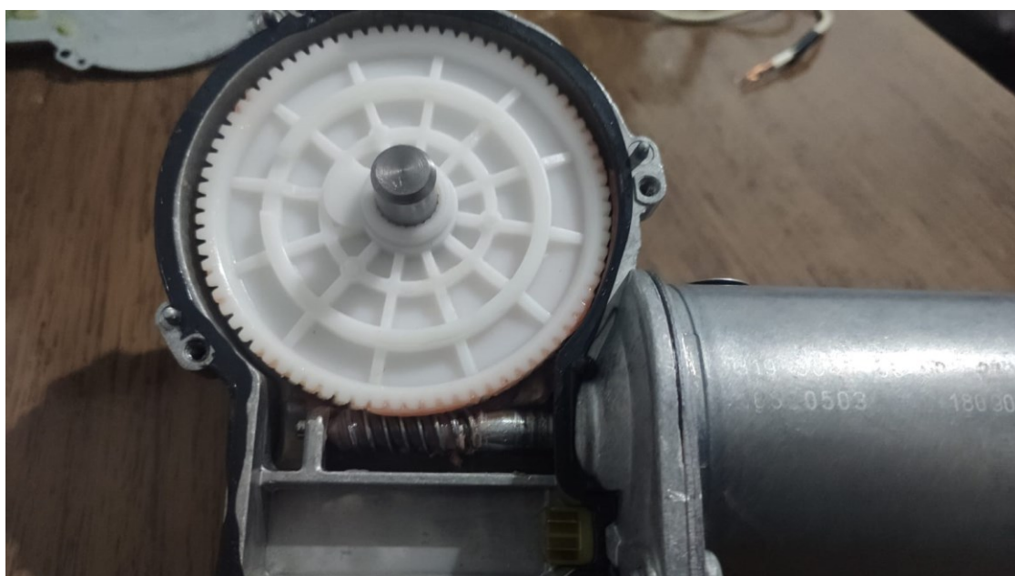
Figura 20 - Sistema redutor do conjunto eletromecânico.
