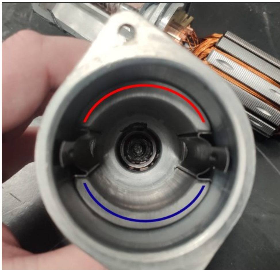
Figura 23 - Detalhamento dos ímãs permanentes.
