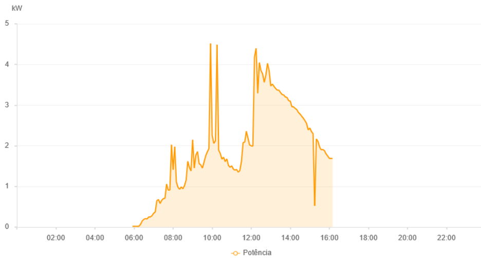
Gráfico 7 – Medidas de potência de um módulo fotovoltaico
