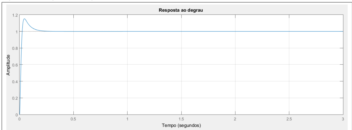
Figura 22 – Resposta ao degrau, utilizando EQM, simulado no Matlab .
