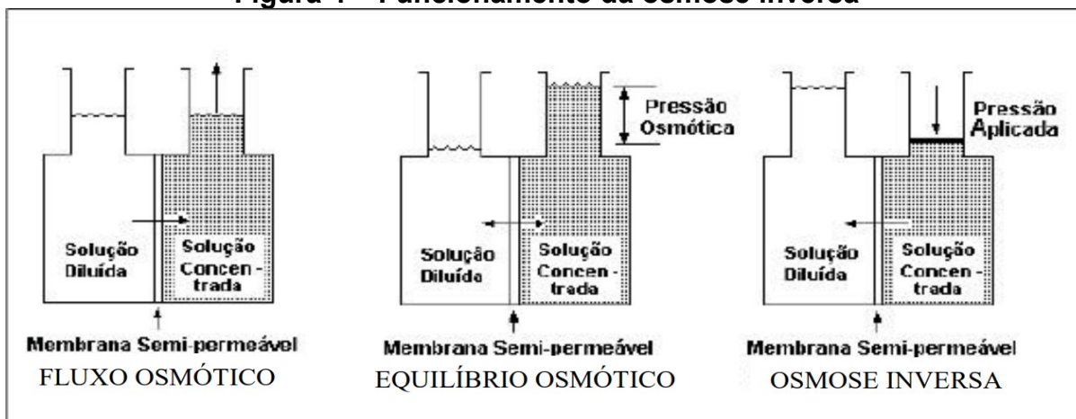
Figura 4 – Funcionamento da osmose inversa
