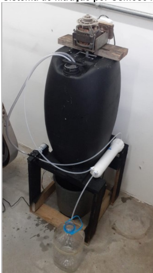
Figura 5 – Sistema de filtração por Osmose Inversa (OI)
