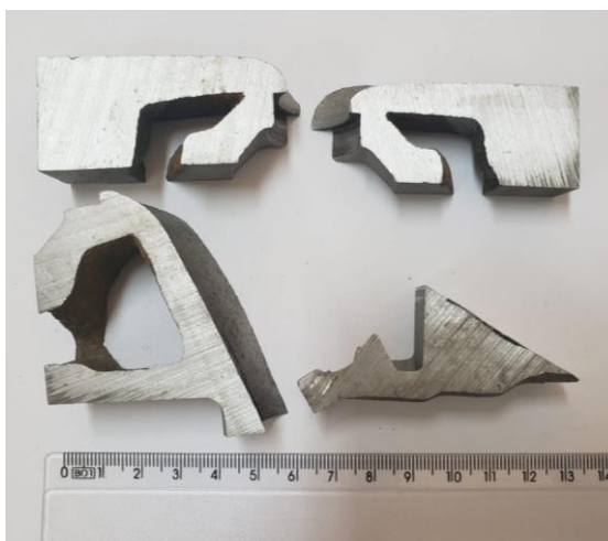
Figura 6 - Amostra A (fundida convencionalmente – retirada de cabeçote de um motor automotivo)
