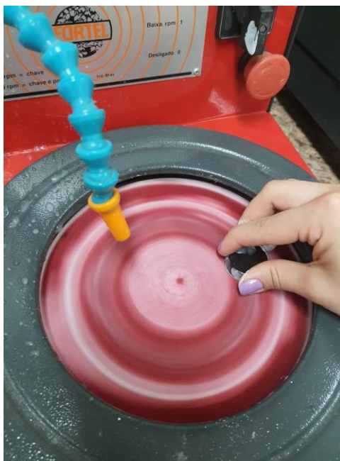
Figura 9 – Polimento da amostra C (embutida em baquelite)
