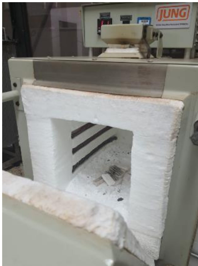
Figura 11 - Corpos de prova da liga CS + FR dentro do forno
