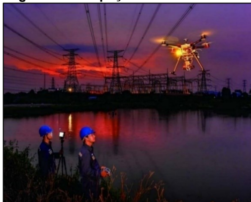
Figura 11 – Inspeção com VANT em LT
