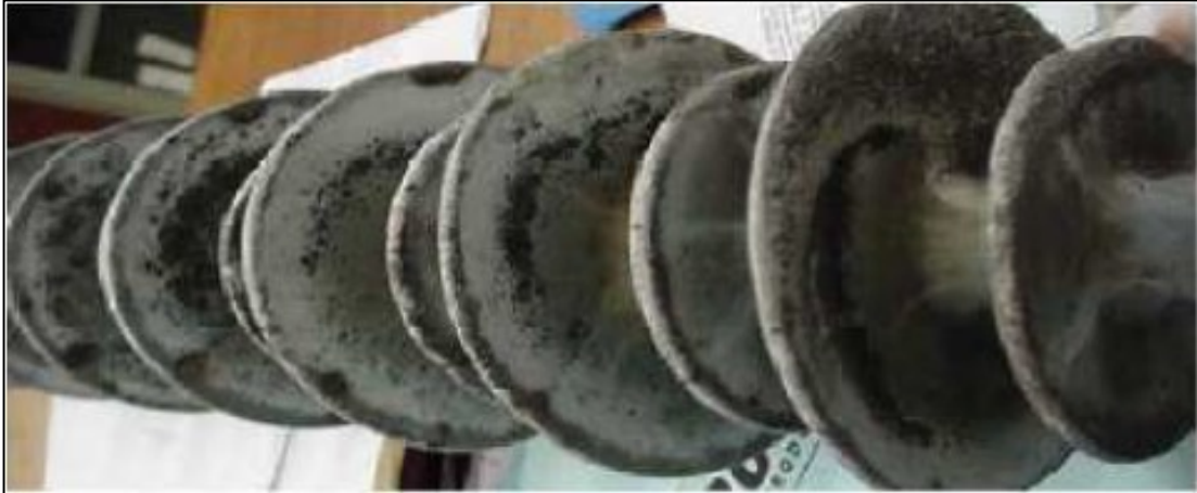
Figura 18 - Isolador polimérico contaminado por fungos
