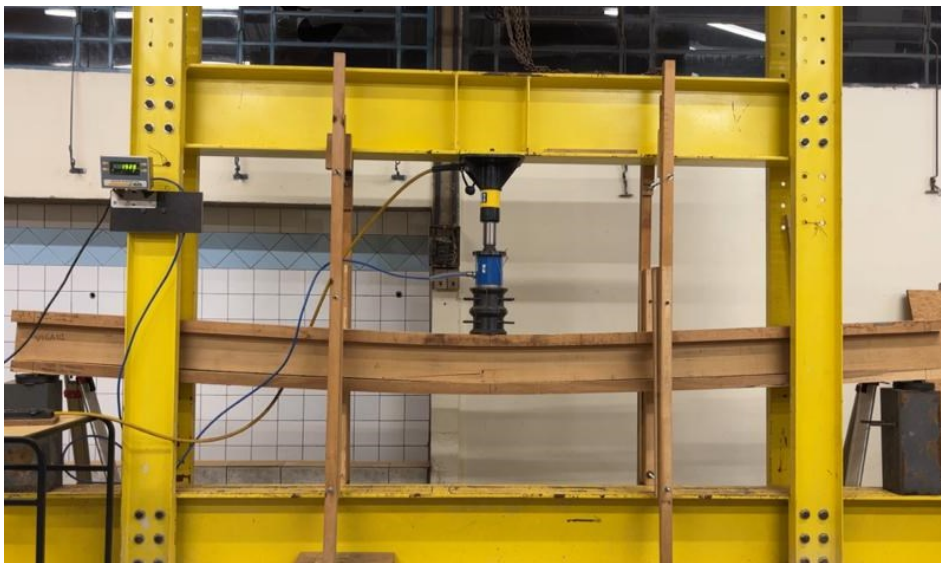
Figura 39 - Viga após ensaio destrutivo
