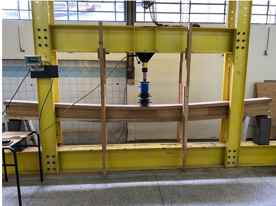
Figura 37 - Viga composta após ruptura
