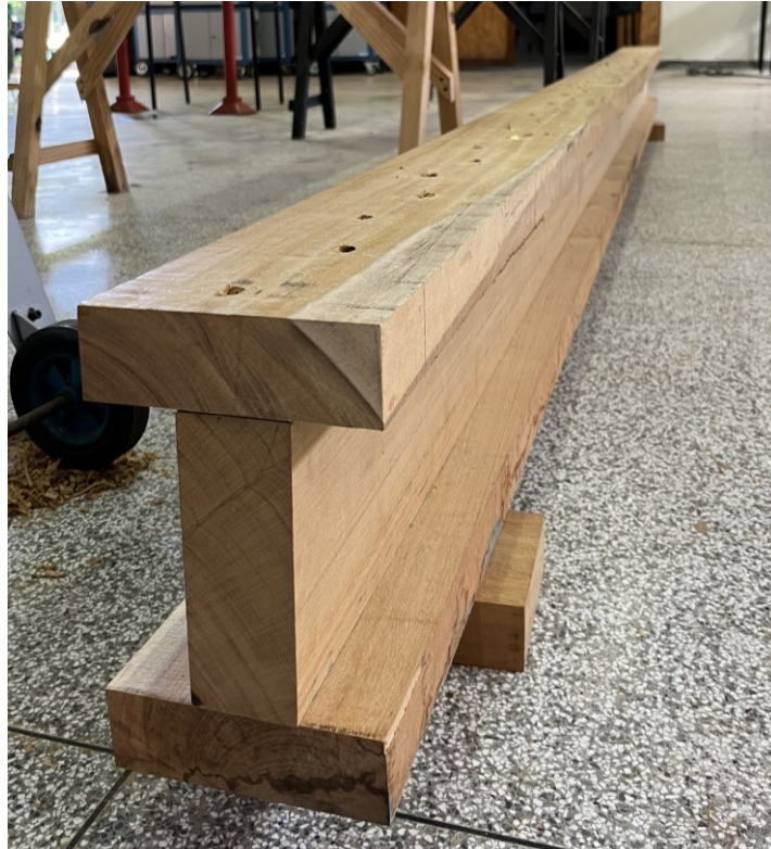
Figura 34 - Viga após finalização da montagem
