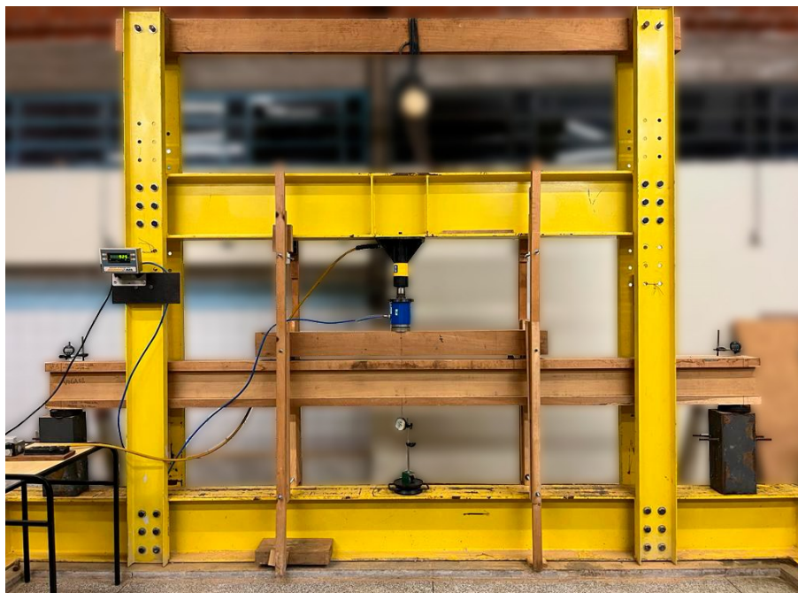
Figura 36 - Viga composta posicionada para ensaio
