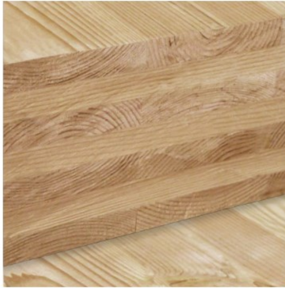
Figura 5 - Exemplo de MLCC (Madeira Lamelada Colada Cruzada)
