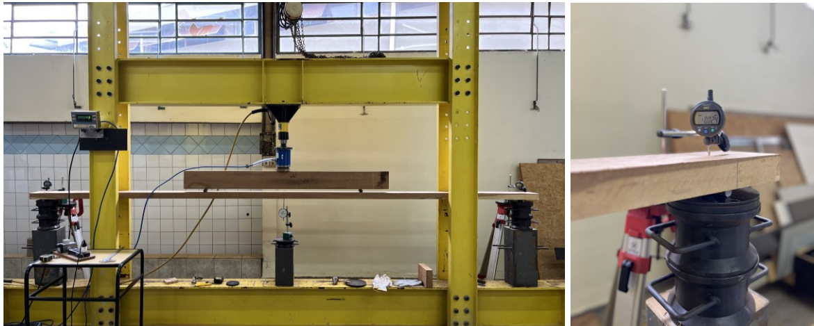
Figura 31 - Ensaio de flexão em peça de mesa
