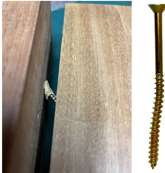
Figura 38 - Rompimento do corpo de prova
