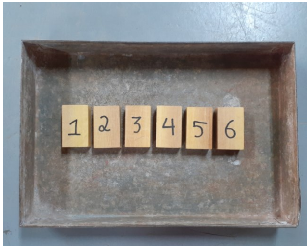
Figura 23 - Corpos de prova para ensaio de umidade e densidade
