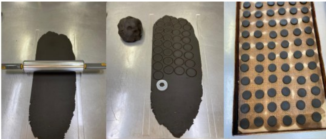
Figura 4- Massa, processo de estampagem e disposição na forma
