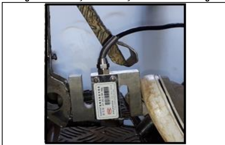
Figura 16 - Aferição do esforço com célula de carga
