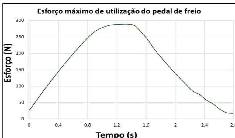
Figura 17: Carregmento no pedal ao longo do tempo de frenagem
