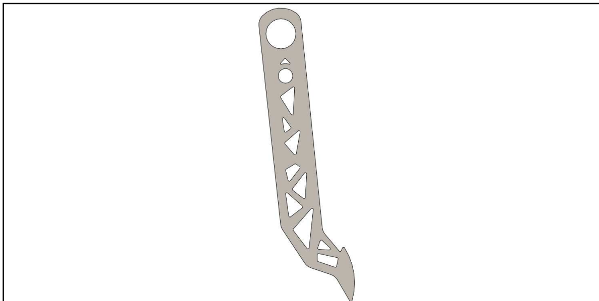
Figura 29 – geometria otimizada após suavização dos contornos
