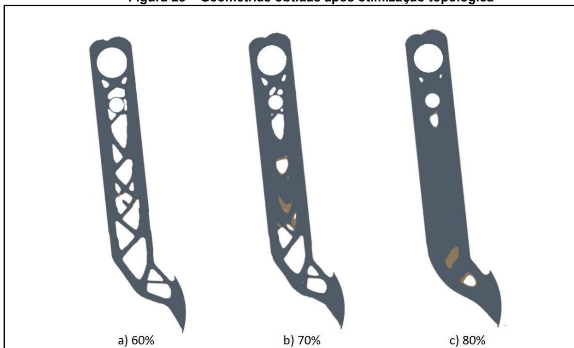
Figura 28 – Geometrias obtidas após otimização topológica
