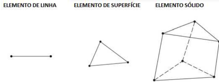
Figura 2 – Elementos de linha, superfície e sólido.
