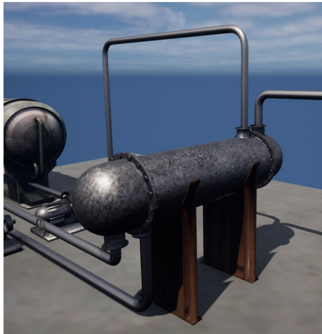
Figura 23 – Área do trocador de calor
