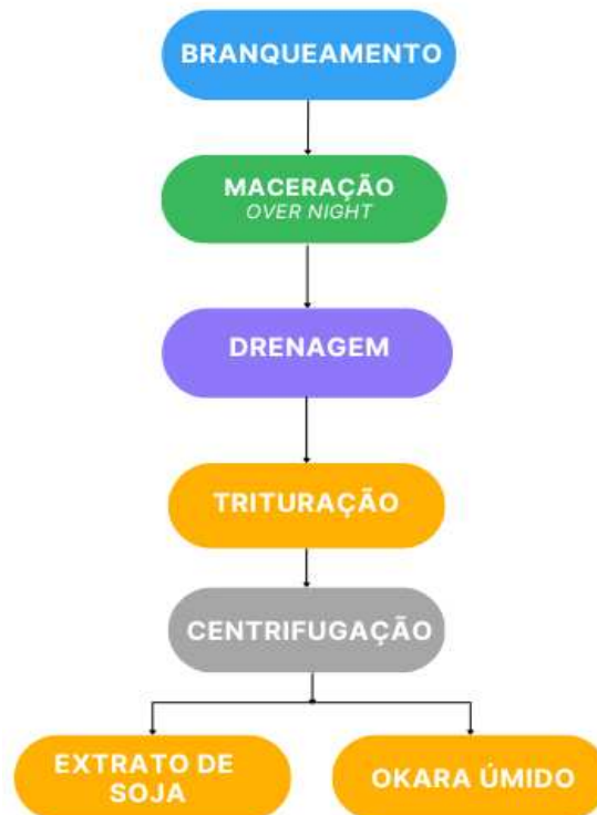
Figura 3 – Fluxograma processo de obtenção do okara
