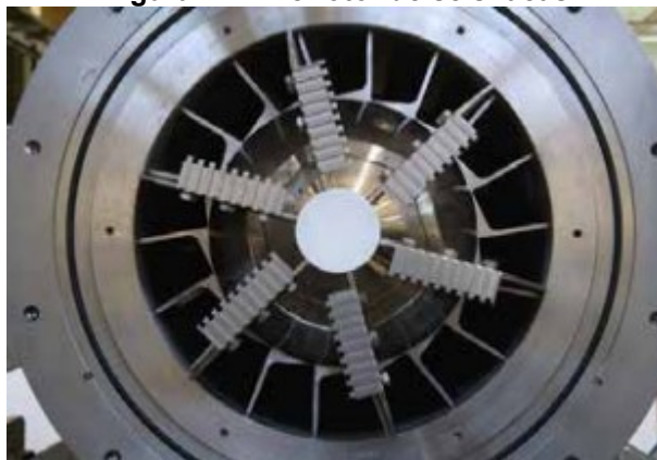
Figura 44 - Pré rotor de seis facas
