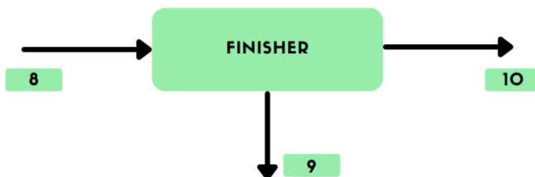
Figura 33 - Volume de controle do finisher do limão
