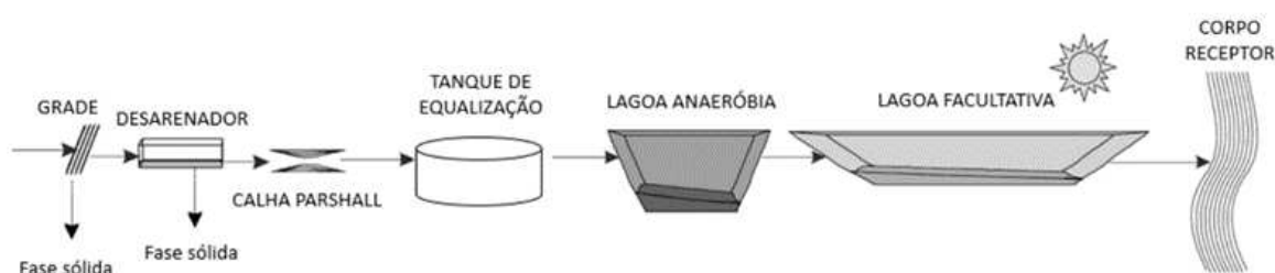
Figura 1 - Fluxograma tratamento de efluentes
