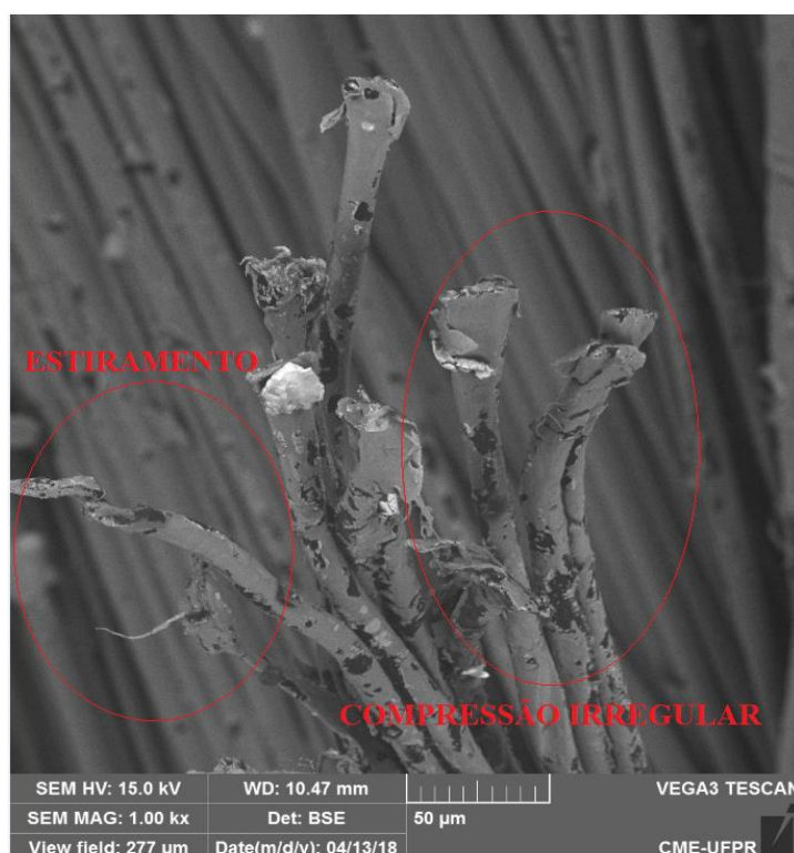
Figura 57 - Análise de fratura por MEV da quarta lâmina da amostra A12 em região de compressão do projétil com velocidade de 435 m/s (tiro 1).
