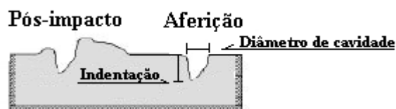
Figura 27 – Esquema da aferição de diâmetros de cavidade e indentação na plastilina após o aplainamento
