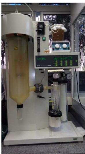
Figura10 - Equipamento mini spray dryer de bancada utilizado nas secagens das amostras de feijoa.
