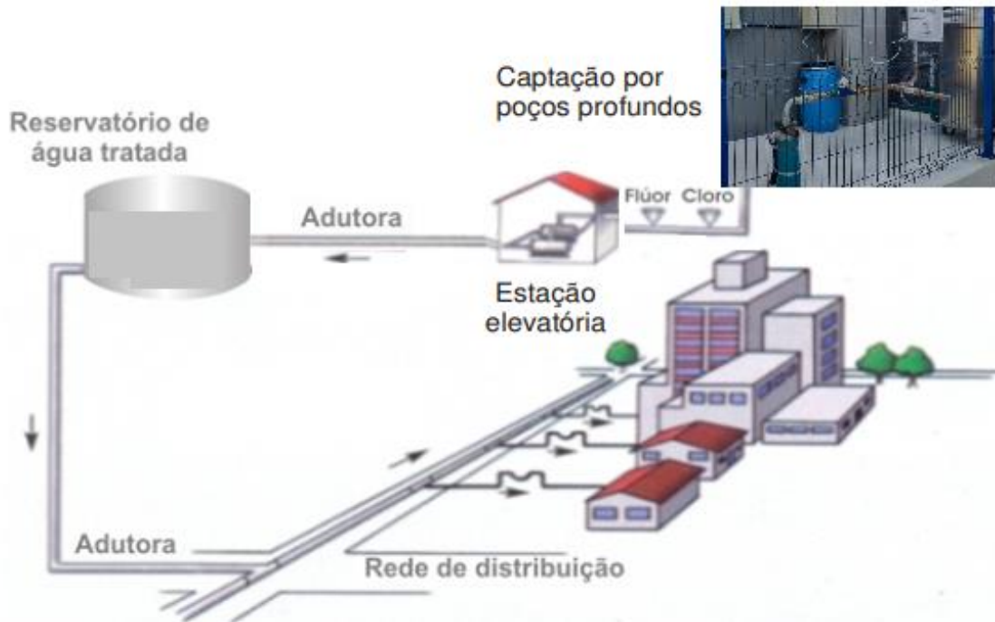
Figura 6 – Abastecimento Poços Profundos e seus Componentes
