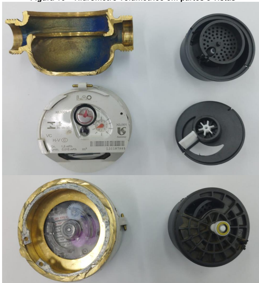
Figura 16 – Hidrômetro volumétrico em partes e vistas
