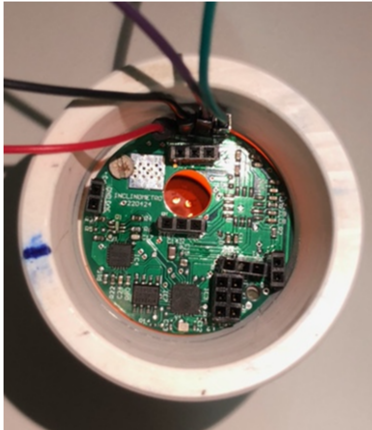
Fotografia 8 – Circuito do módulo escravo fixado e em funcionamento no interior da luva
