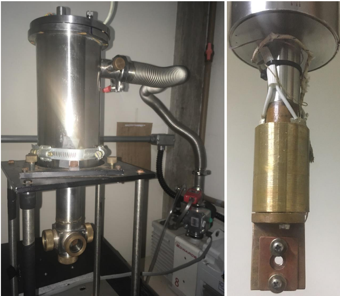
Figura 6 - Criostato de dedo frio utilizado para as caracterizações ópticas do filme de perovskita. A imagem da direita representa o porta amostras deste criostato.
