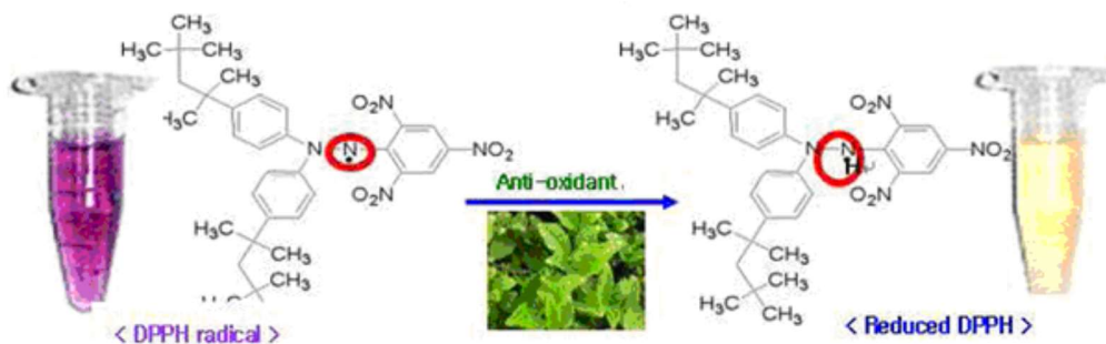
Figura 7- Exemplo de mudança de cor do radical DPPH após reagir com antioxidante (RUFINO et al., 2007).
