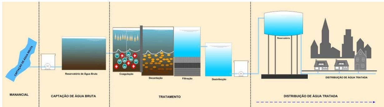
Figura 8– Sistema de abastecimento de água (ciclo completo)
