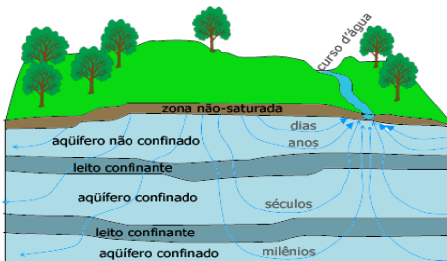
Figura 5 - Área de recarga e descarga dos aquíferos.
