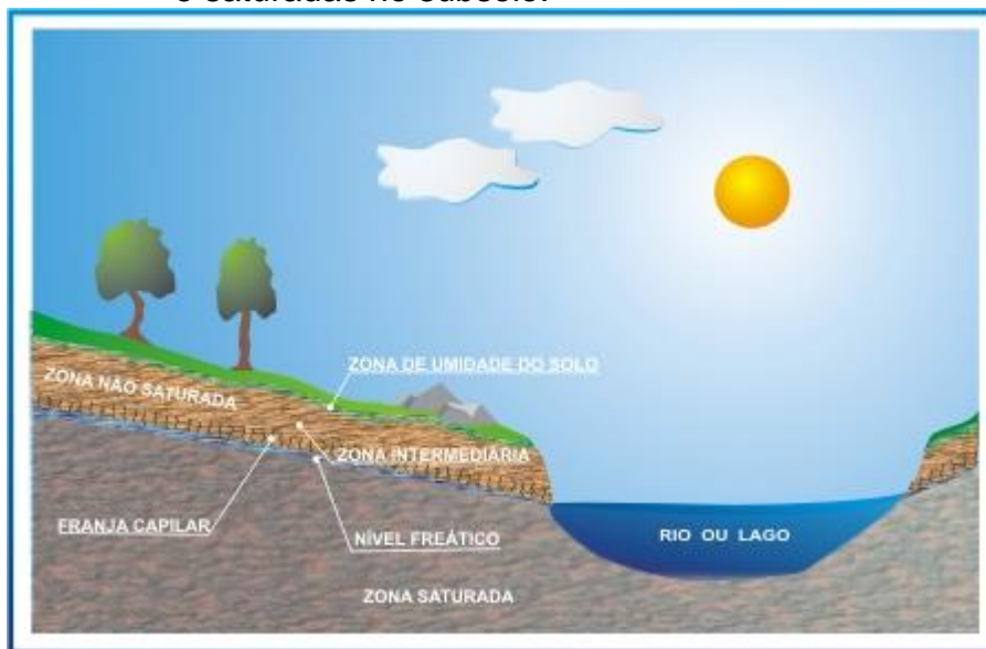
Figura 2 – Caracterização esquemática das zonas não saturadas e saturadas no subsolo.
