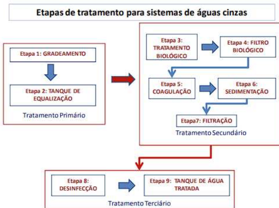
Figura 8 – Etapas de Tratamento da água Cinza
