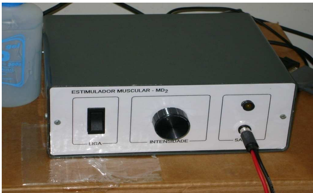
FIGURA 12– EQUIPAMENTO II – ELETROESTIMULADOR MD2, 2 CANAIS SINCRONIZADO COM A RESPIRAÇÃO DO INDIVÍDUO .
