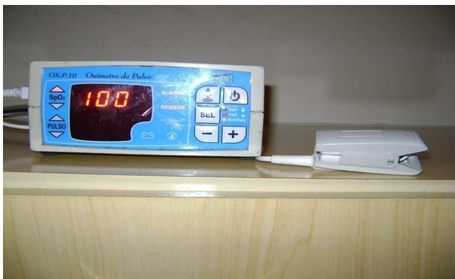
FIGURA 8- OXÍMETRO DE PULSO UTILIZADO PARA A MENSURAÇÃO DA SpO 2 E FREQUENCIA CARDÍACA, UTILIZADO ANTES E DEPOIS DA ESTIMULAÇÃO ELÉTRICA.
