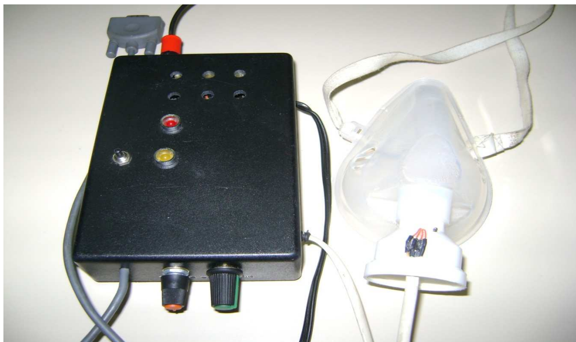
FIGURA 14 – MÁSCARA COM OS SENSORES DE TEMPERATURA ACOPLADO À UMA MÁSCARA DE OXÍGENIO CONECTADA AO MICROCONTROLADOR (SINCRONIZADOR) .
