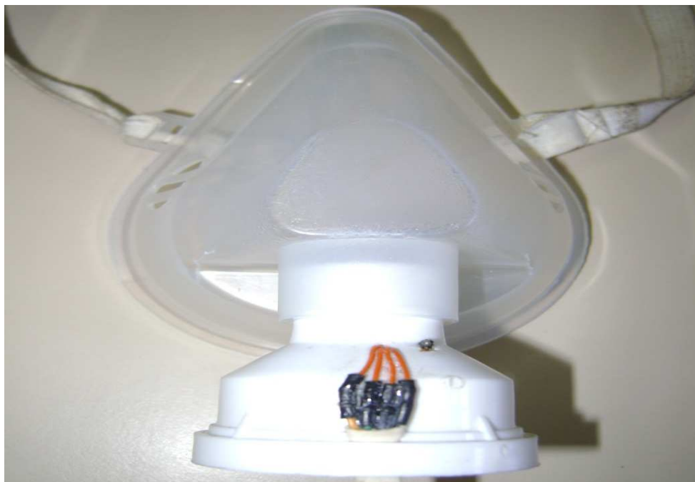
FIGURA 13- SENSORES DE TEMPERATURA POSICIONADOS NA REGIÃO EXTERNA E INTERNA DA MÁSCARA DE OXÍGENIO.
