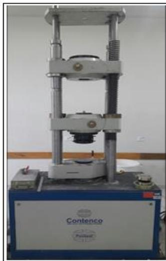
**Figura 40** - Prensa hidráulica utilizada para rompimento dos corpos de prova.
