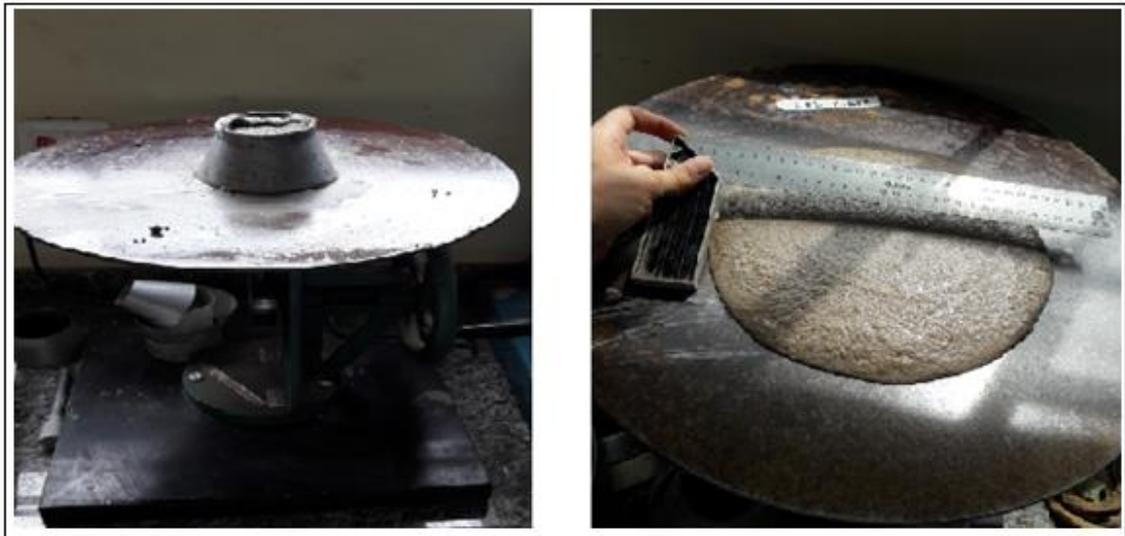
**Figura 34** - Determinação da água requerida para o ensaio da NBR 5751:1992.
