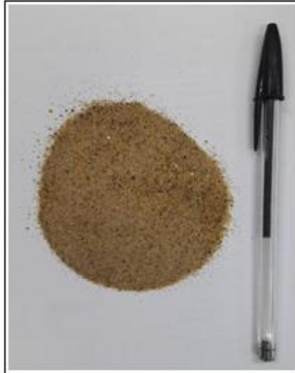
**Figura 21** – Aspecto do agregado miúdo.
