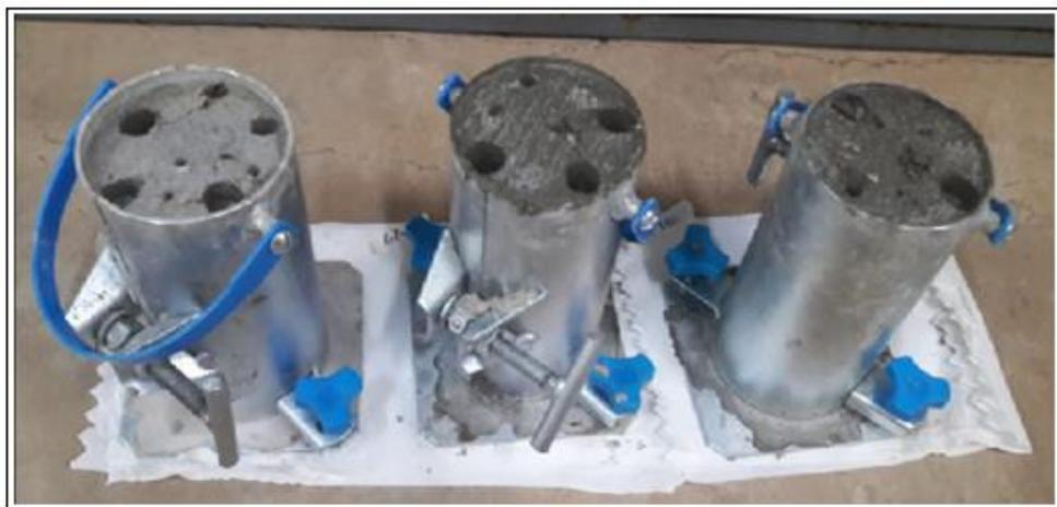
**Figura 38** – Ensaio pelo método penetrômetro de Proctor.
