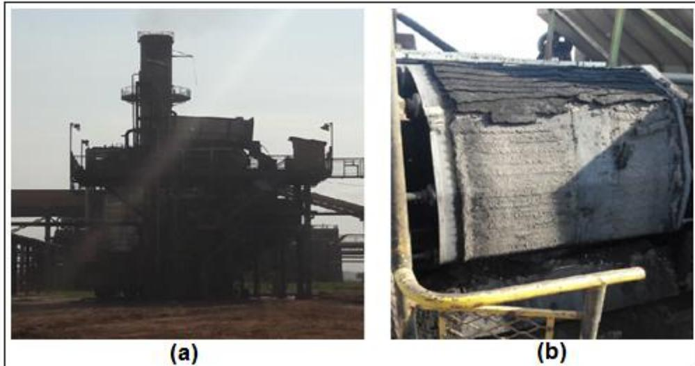
**Figura 17** – Lavador de gases (a) e esteira do lavador de gases (b), Usina sucroalcooleira Umuarama – PR.
