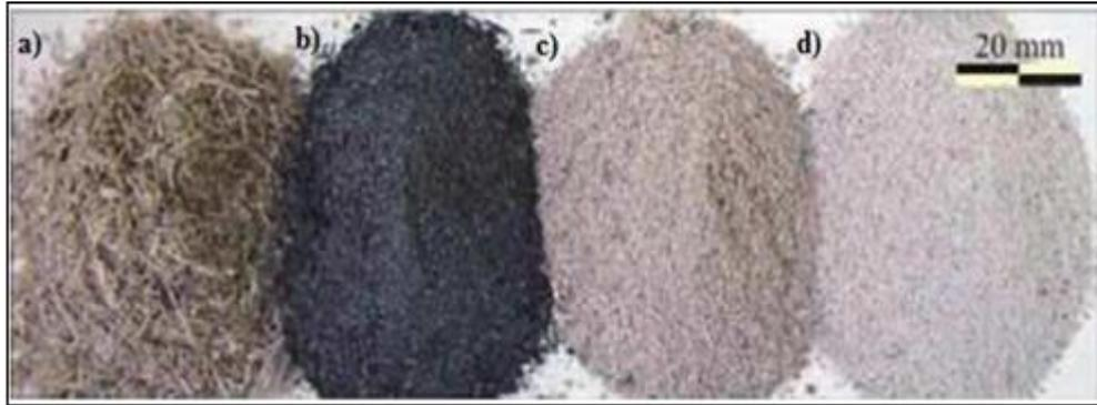
**Figura 12** – Modificação da coloração conforme o tempo de queima nas caldeiras. Bagaço de cana-de-açúcar (a), cinza escura alto teor de carbono (b), cinza com menor teor de carbono (c) e cinza gerada após combustão completa (d).
