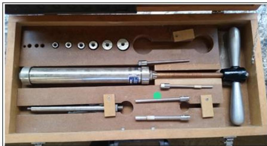
**Figura 37** – Imagem ilustrando penetrômetro de Proctor.
