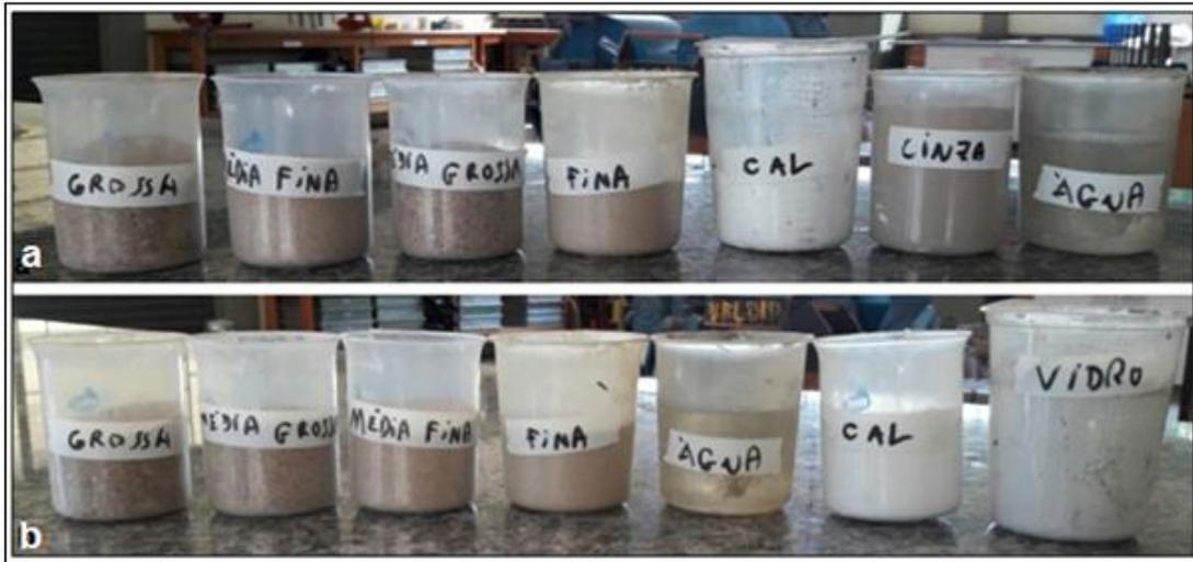
**Figura 35** - Material utilizado no ensaio de índice de atividade pozolânica com cal: CBC (a), PDV (b).
