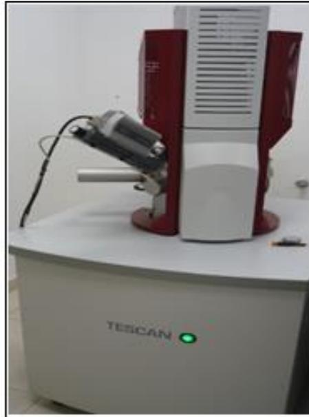
**Figura 31** – Microscópio eletrônico utilizado para análise por MEV.
