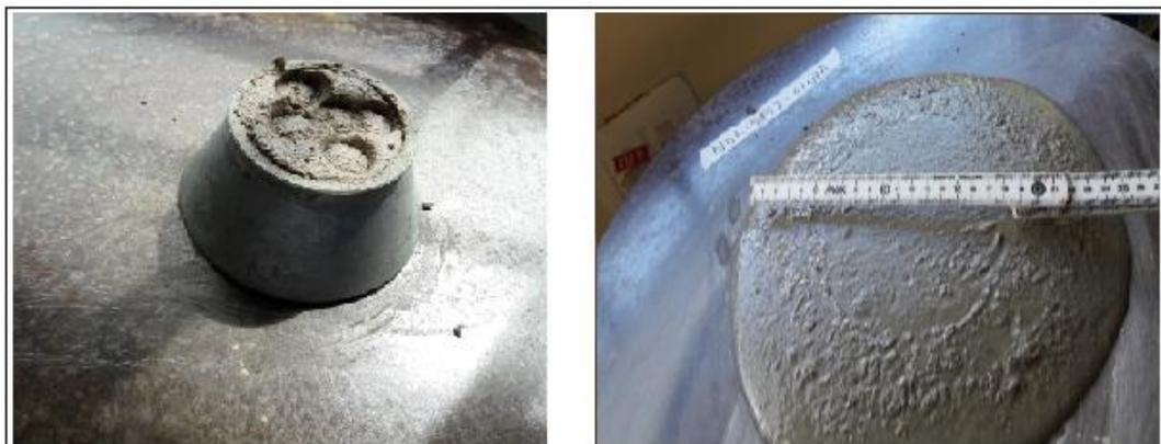
**Figura 33** – Determinação da água requerida para o ensaio da NBR 5752:1992.
