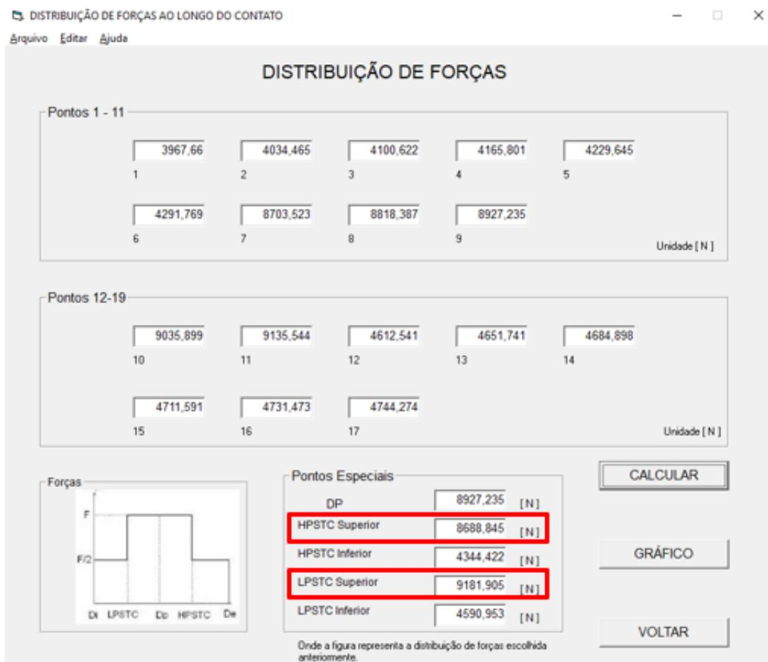
**Figura 67 - Distribuição de forças ao longo da extensão do flanco do dente**
