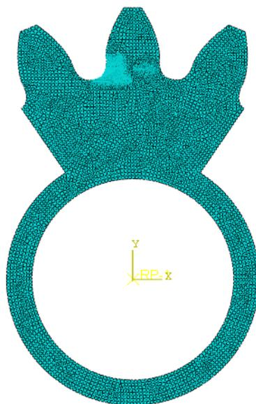
**Figura 46 - Malha utilizada no modelo global**
