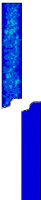
**Figura 108 - Estado final do elemento fraturado após número completo de ciclos**
