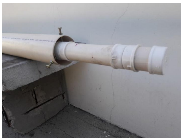
Figura 9 - Foto da extremidade superior da coluna de testes mostrando os parafusos de fixação do sistema (Autoria própria).
