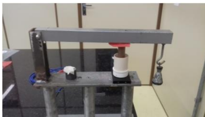
Figura 8- Suporte usado para calibrar a cabeça do sensor (Autoria própria).
