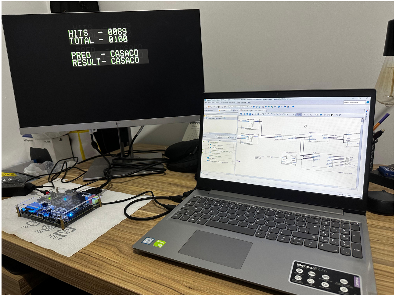
Figura 27 - Exibição dos resultados da rede neural pela FPGA em um monitor
