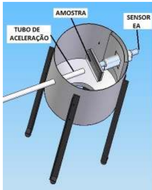
Figura 3.18 – Vista isométrica do coletor de partículas com posicionamento do porta amostra, tubo de aceleração e local para acoplamento do sensor de EA.
