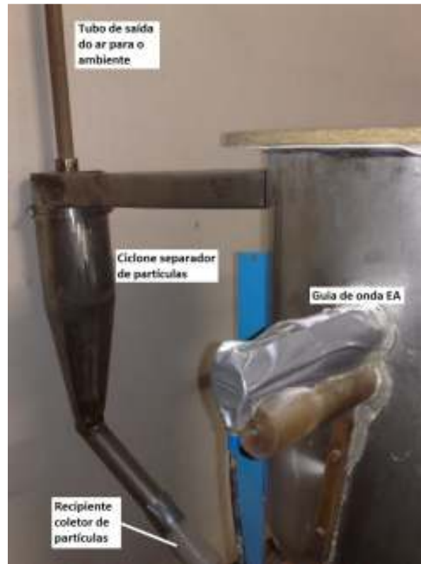
Figura 3.20 - Montagem do ciclone separador de partículas no erosímetro.
