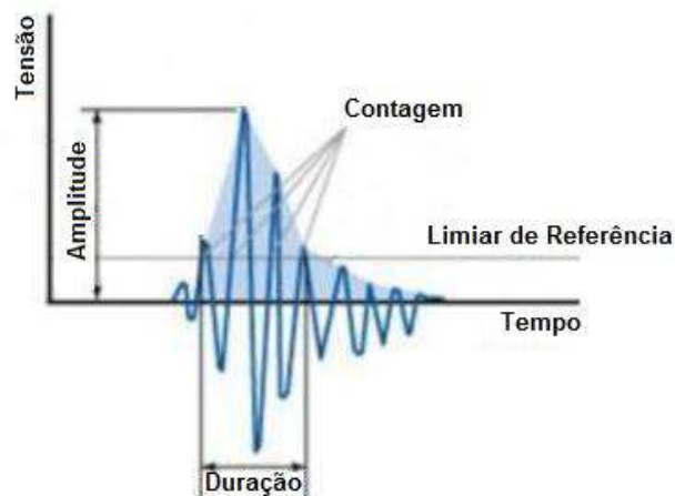
Figura 2.21 - Parâmetros de um sinal de EA (TIBONI, et. al. , 2009).
