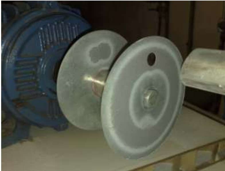
Figura 3.22 - Aparato utilizado para determinação da velocidade das partículas.
