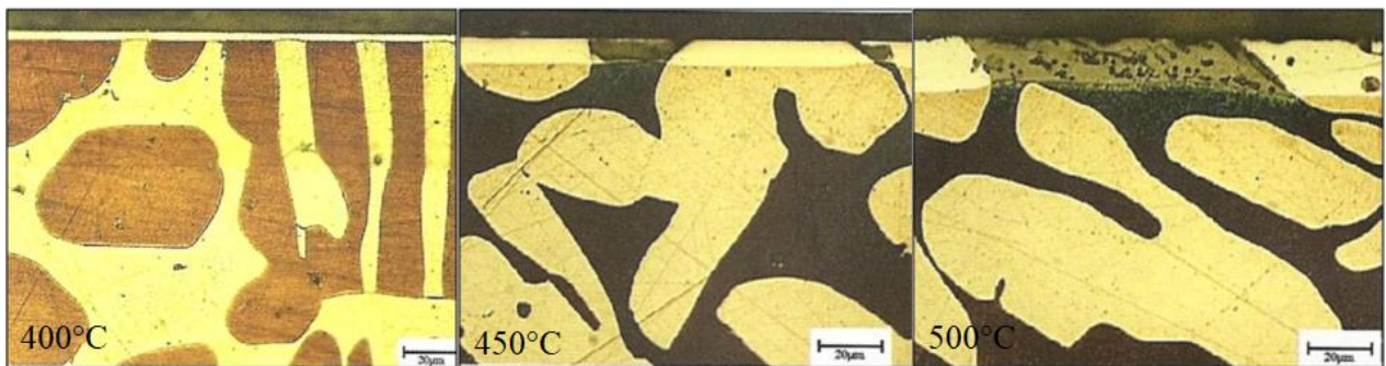
Figura 2.3. Diferença nas espessuras das camadas nitretadas em aço duplex para temperaturas de a 400°C, 450°C e 500°C respectivamente (CASTELETTI, et al. , 2010).
